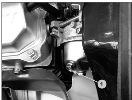
Рис. 17 Слив топлива из карбюратора
